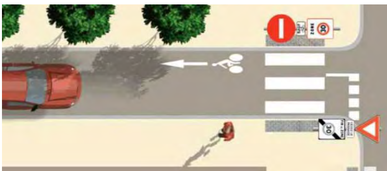
Exemples de gestion des entrées et sorties de zone 30 pour différentes intersections.
